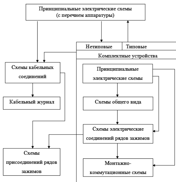
Рис. 1. Структура рабочей документации схемотехнической части проекта
